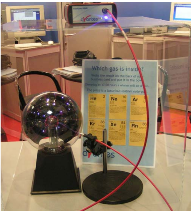
图 12 用 AvaSpec-2048 光谱仪测量惰性气体高压放电等离子体的实际照片
