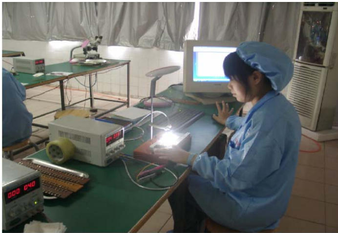
图 10 大功率白光 LED 在线监测
