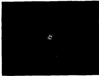
图 2 调 Q 脉冲激光的远场照片
