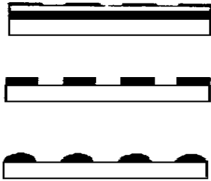
图1 光刻热熔微透镜阵列制作过程
