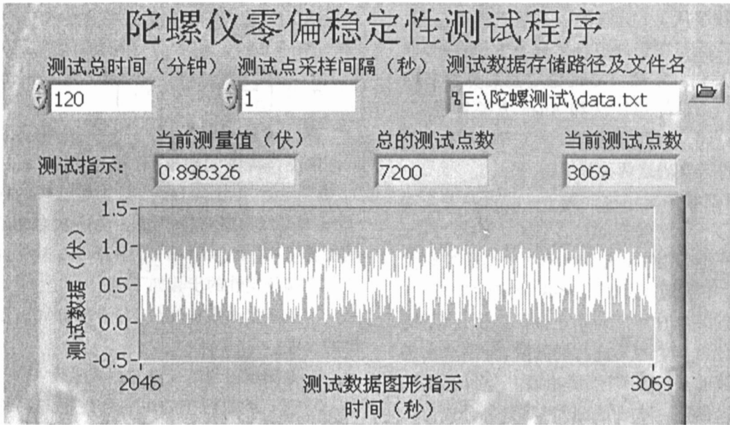
图 1 基于 GPB 虚拟仪器的陀螺仪零偏稳定性测试程序 LabV IEW 软件界面
