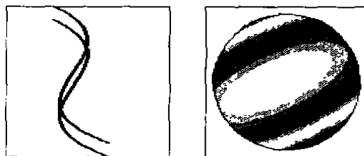
图 2 剪切干涉法测量波前相位
