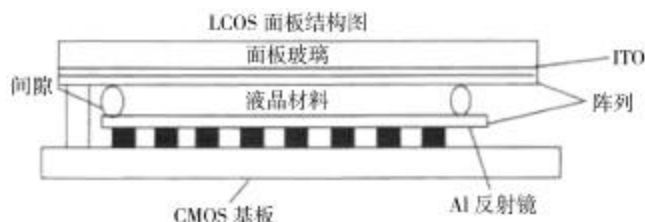
图3 LCOS 芯片结构图解
