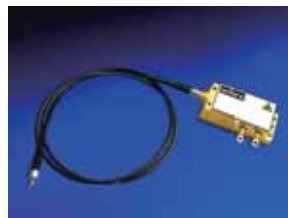
Prosario系列高功率光纤耦合Bar模块 说明：波长范围780-980nm，功率大于50W，光纤芯径400-800 可选 应用：激光打印
