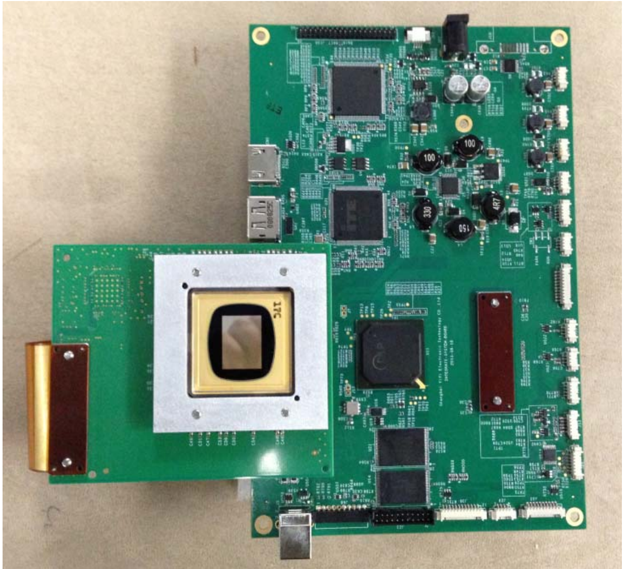
0.95" DMD 系统电路板整体图
