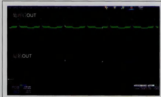
图 7 CCD 原始 V_{out} 及处理后 V_{out} 的波形图
