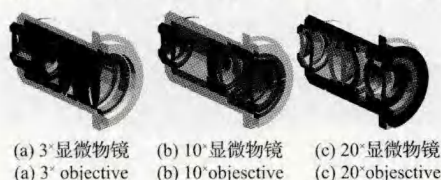
图 7 显微成像物镜光机系统仿真设计结果
