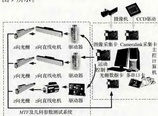
图 9 电控系统工作原理
